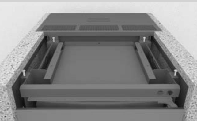
Die Topplattenschrauben so einstellen, dass sich ein Abstand von Schraube zur Oberkante des Steinlements von 2 cm ergibt.
