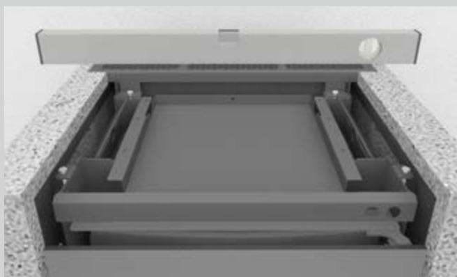
Con un nivel de burbuja de aire, controle si el borde superior de los elementos laterales se encuentra a la misma altura que la parte superior del envolvente de acero.
