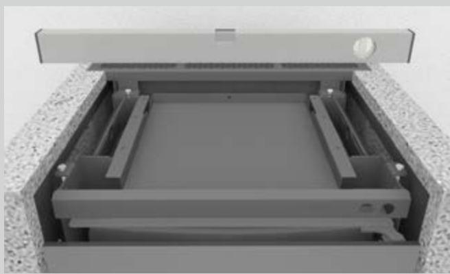
Utilizzare una livella a bolla d'aria per verificare che il bordo superiore degli elementi laterali si trovi sullo stesso livello del bordo superiore dell'intelaiatura in acciaio.
