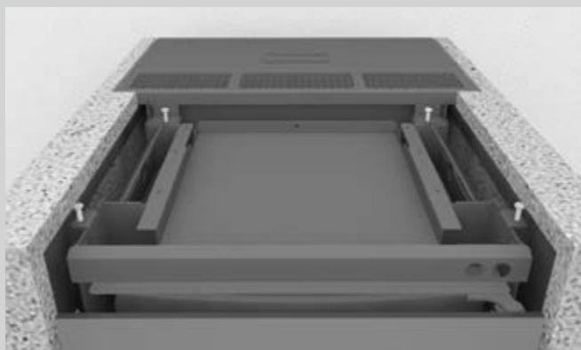
Il faut régler les vis de support réglables de sorte à obtenir une distance libre entre le dessus des vis et le bord haut des pierres égale à 2 cm.
